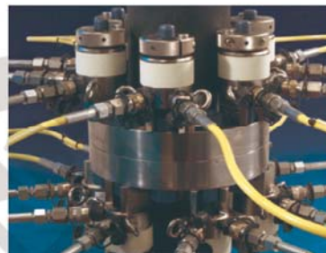
● 海底管道法兰盘螺栓同步拉伸预紧
