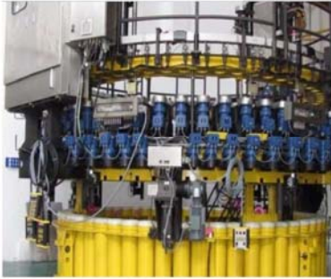
● 核泵螺栓同步拉伸预紧
