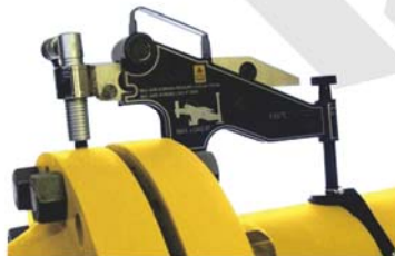
● 石油管道法兰盘错位调整
