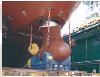
● 螺旋桨同步提升安装
