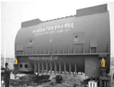
● 大型电机检修长期支撑
