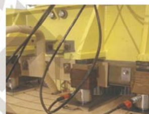
● 大型变压器组装压紧
