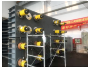
● 混凝土盾构管片加载试验
