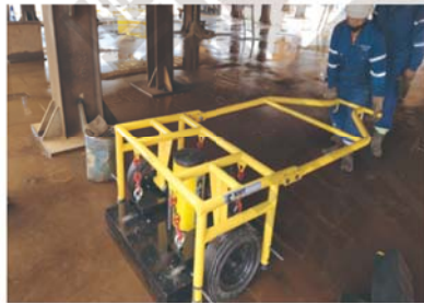
● 钻井平台模块同步分级顶升称重
