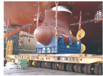
● 螺旋桨同步提升安装
