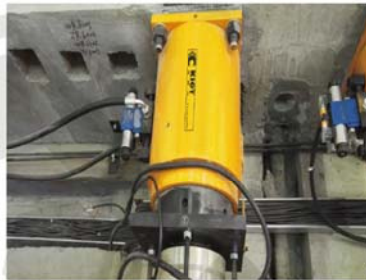
● 混凝土结构强度测试
